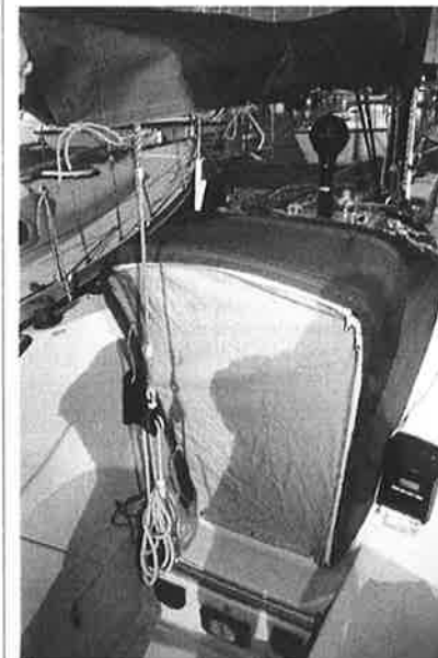
Det akte tygskyddet på sprayhooden ger ett större utrymme nere i ruffen med 'stängd lucka'. På rufftaket syns kompassen som är upphöjd för att synas även sittande. Där finns också fallvinschen med avlastare till diverse trimlinor. Under fotstegen på skotten sitter logg och ekolod. Storskotet har försetts med en skena för bättre trimmöjlighet och ett par extra vinschar sitter på sargkanten.
