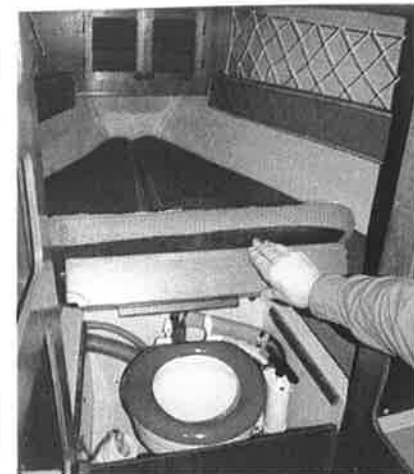
Med lite träarbete och nytt tyg kan man fräscha upp sin gamla, spartanska Maxi 77. Här har man installerat en riktig båttoalett med septiktank under förpikskojens läggsskiva. Ett snyggt förvaringsskåp är byggt längst fram i förpiken, och de långsgående hyllorna är 'påbyggda' med nät. Båten är från 1975 och tillhör Urban Edvardsson i Mölndal.
