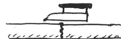
Fogen som nu är lika stark som listen i övrigt snyggas till med ett strykjärn. OBS det är viktigt att plåten är riktigt varm så att PVC-plasten börjar att smälta.
